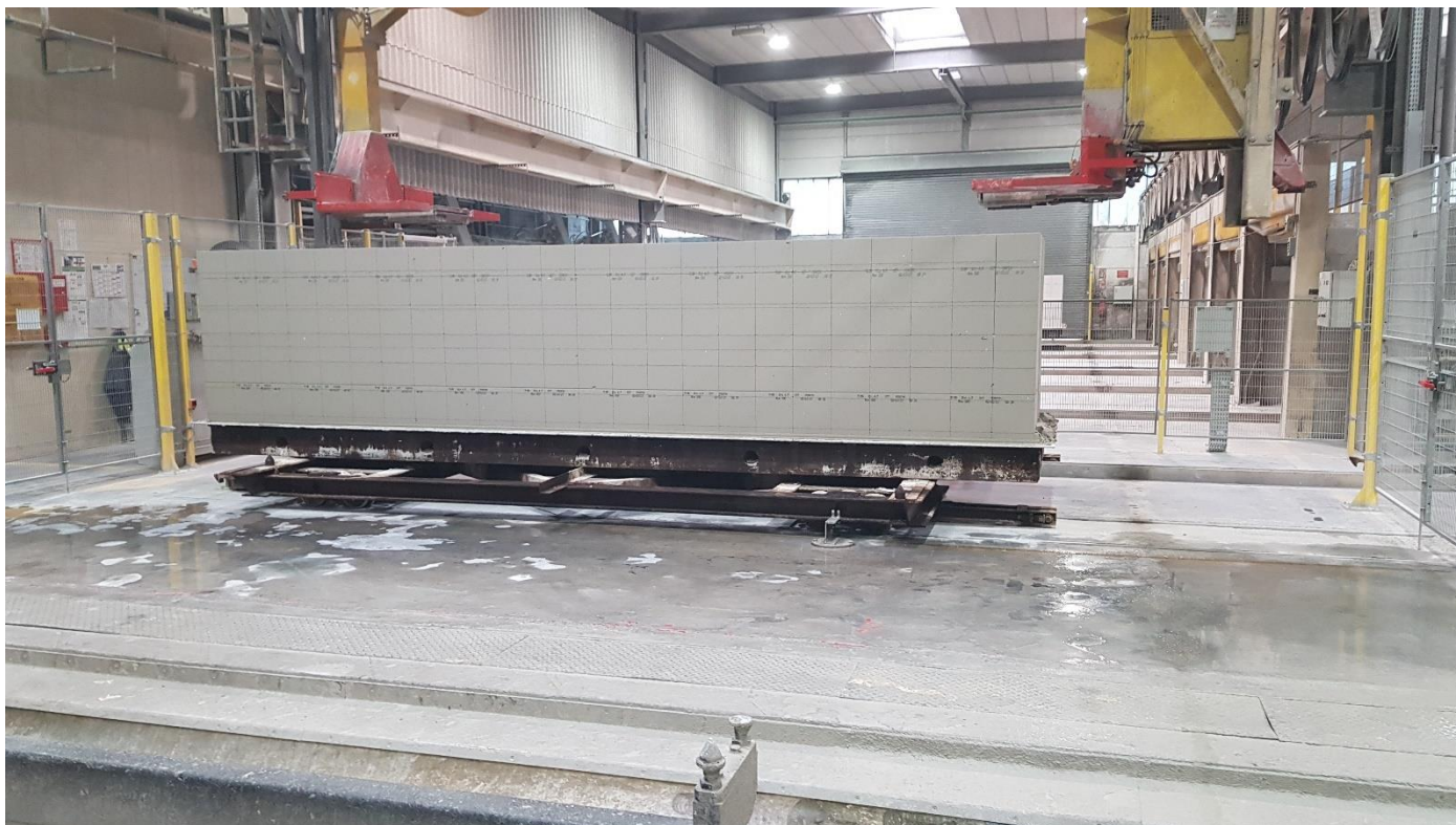
Figure 3: Vue interne de l'usine et d'un bloc de béton cellulaire
